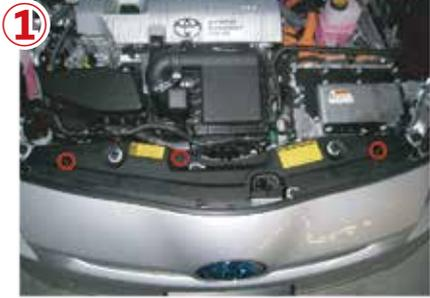
① ラジエターフードの3か所のクリップを取り外します。
