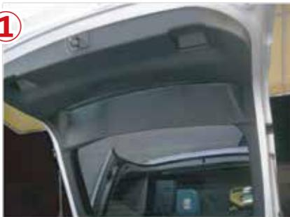
バックゲートのパネルをはずします。
