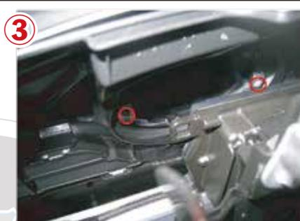
③ エンブレムを止めている2本のネジを外し、爪を緩めると純正エンブレムが外れます。
